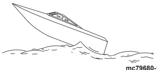
Le passage de vagues ou de sillages par les bateaux de plaisance fait partie de la navigation. Cependant, si cette activité est réalisée à une vitesse suffisante pour forcer la coque du bateau à sortir en partie ou entièrement de l'eau, certains risques existent, particulièrement lorsque le bateau reprend contact avec l'eau.
