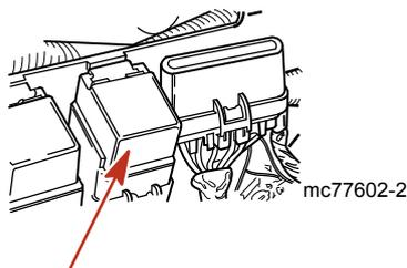
4. Le système de relevage hydraulique est protégé contre les surcharges par un fusible de 110 A et un fusible à fourche de 20 A situés sur la pompe de relevage hydraulique. La pompe de trim peut aussi être dotée d'un dispositif de protection du circuit en ligne dans le fil positif de relevage hydraulique près de l'interrupteur de batterie ou de la connexion de la batterie.
