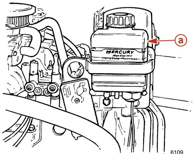
**a** - Contrôleur de graissage d'embase
