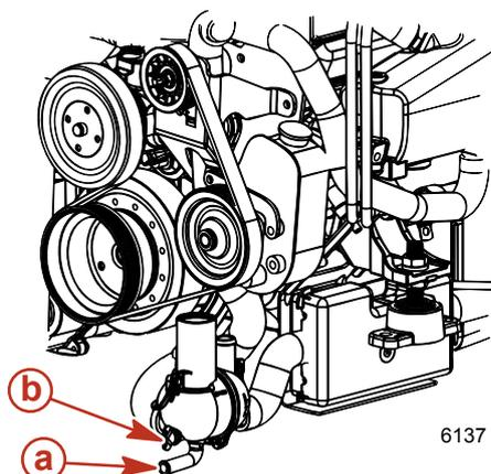
**a** - Emplacement de l'orifice de vidange - **b** - Bouchon de vidange bleu orange ou rouge
