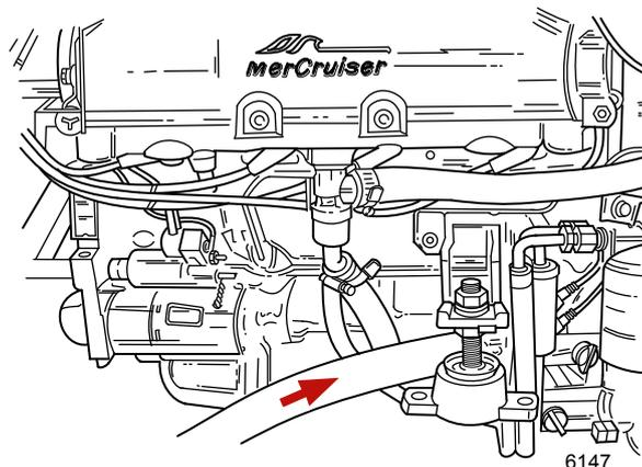
6. À l'aide d'un adaptateur conforme, brancher le tuyau de nettoyage provenant de l'alimentation en eau à l'arrivée d'eau de la pompe à eau de mer.
