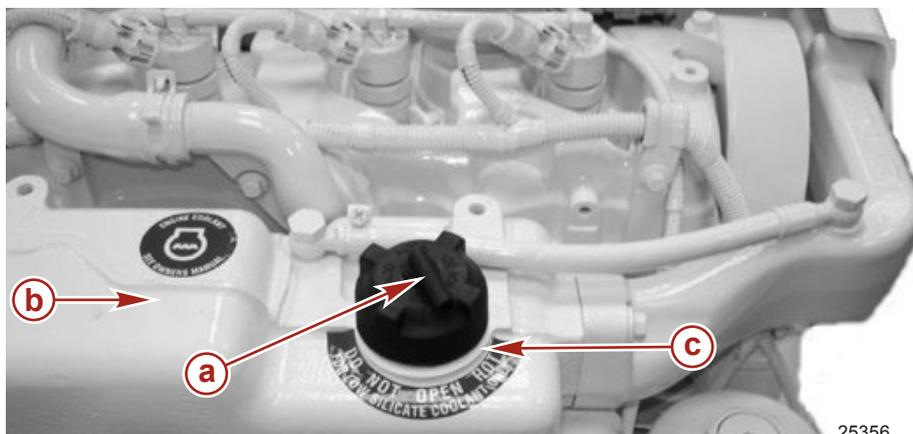
**Emplacement du bouchon du liquide de refroidissement du moteur (capot moteur retiré)**
