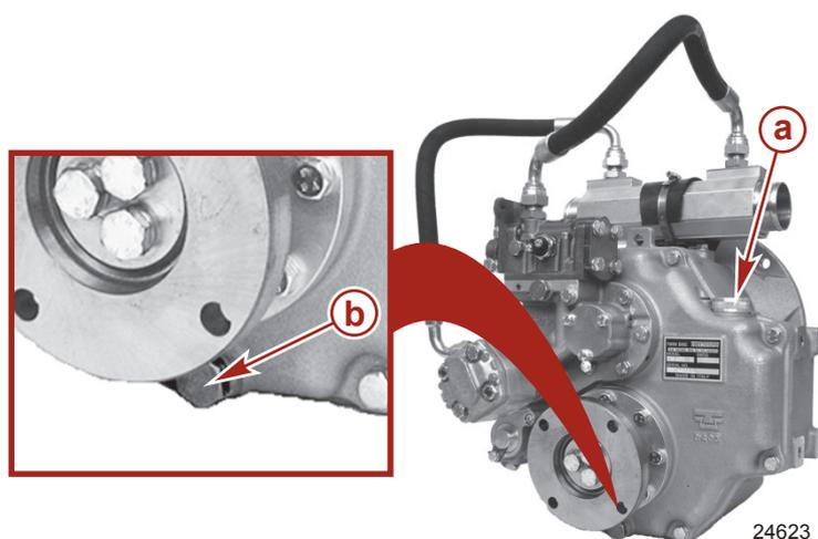
**a** - Bouchon de remplissage et jauge d'huile
