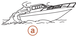
a - Angle de relevage de la proue trop élevé
