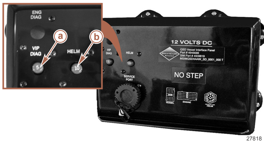
Coupe-circuits du panneau d'intégration du bateau (VIP)
