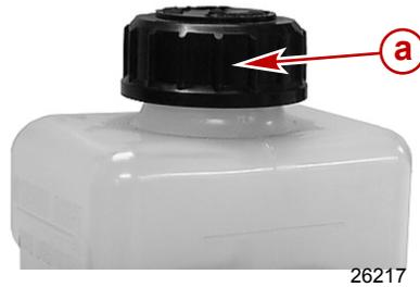
**a** - Bouchon du contrôleur de graissage d'engrenages
