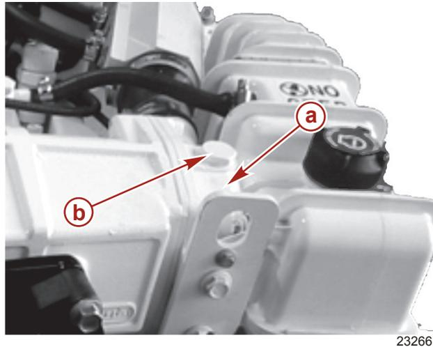
**a** - Couvercle d'extrémité du refroidisseur      **b** - Montage des anodes
