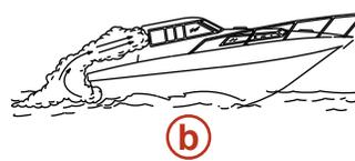
**b** - Écoutilles avant fermées (aspiration à l'intérieur des gaz d'échappement)
