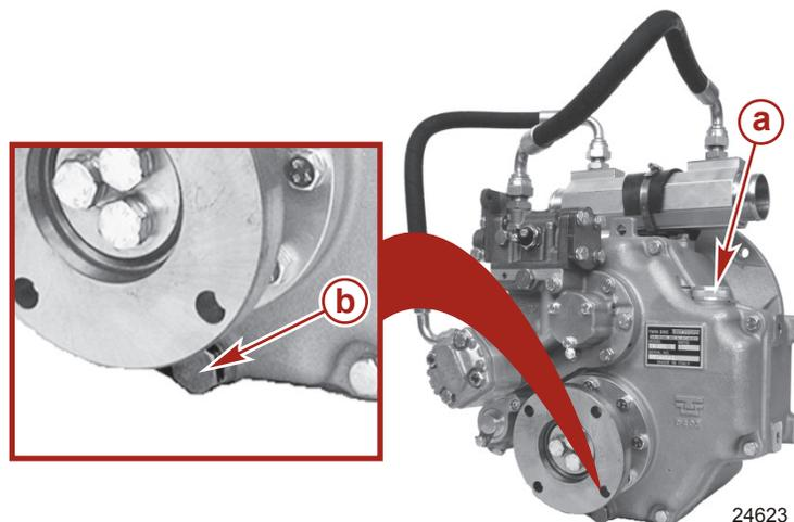
**a** - Bouchon de remplissage et jauge d'huile    **b** - Bouchon de vidange
