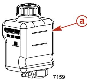
**a** - Contrôleur de graissage d'embase
