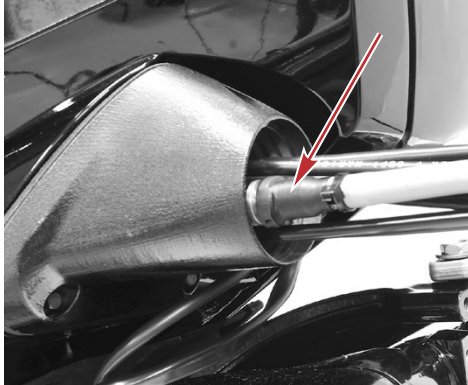
Desconexión rápida del acoplamiento de la manguera de combustible
