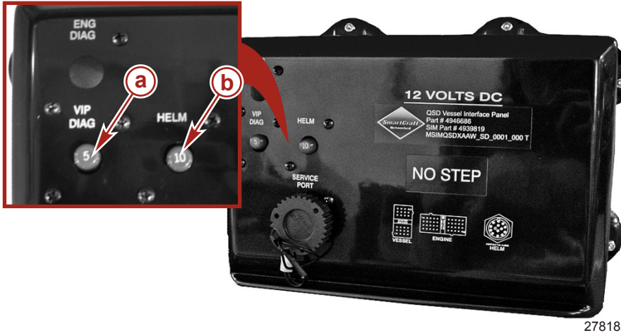
Disyuntores del panel de integración de la embarcación (VIP)
