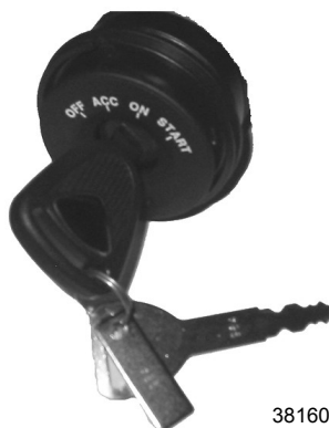
Interruptor de la llave de encendido de cuatro posiciones
