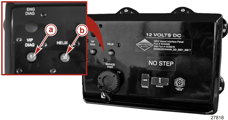
Disyuntores del panel de integración de la embarcación (VIP)
