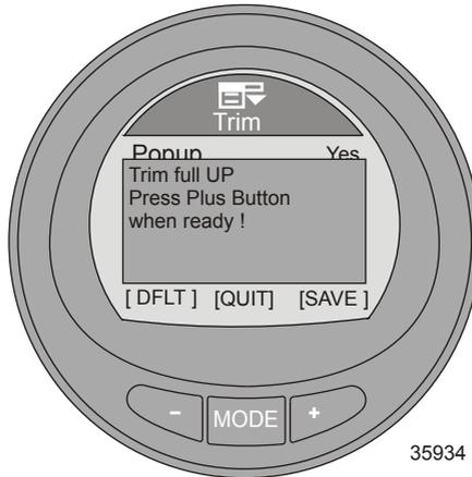
15. Nach dem Drücken der Taste „+“ werden die Anweisungen im Pop-up-Fenster geändert und fordern den Bediener auf, bis in die Trailer-Position zu trimmen und dann die Taste „+“ zu drücken.
