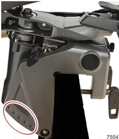
Den vertikalen Betriebswinkel des Außenborders so einstellen, dass der Außenborder bei voller Fahrt senkrecht zum Wasser steht.
