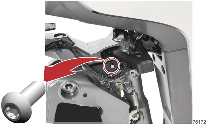
4. Durch Verschieben des Riegels und den Versuch, den Außenborder anzuheben, sicherstellen, dass die Schnellkupplung deaktiviert ist.
