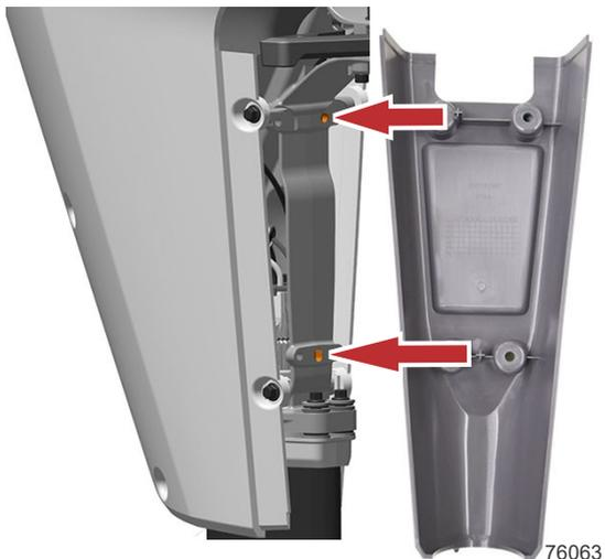
2. Die untere Verkleidung der vorderen Motorhaube mit vier kurzen Sechskantschrauben am Außenborder befestigen.
