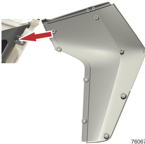
2. Die steuerbordseitige Verkleidung der Motorhaube mit fünf Sechskantschrauben am Außenborder befestigen.
