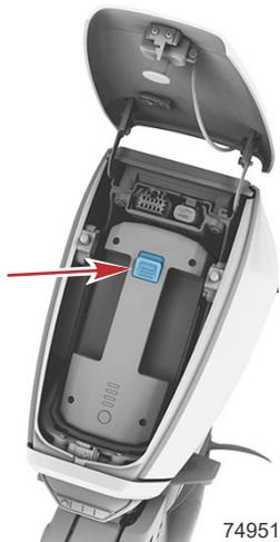
3. Die Batterie auf den Führungsschienen aus dem Außenborder herauschieben.
