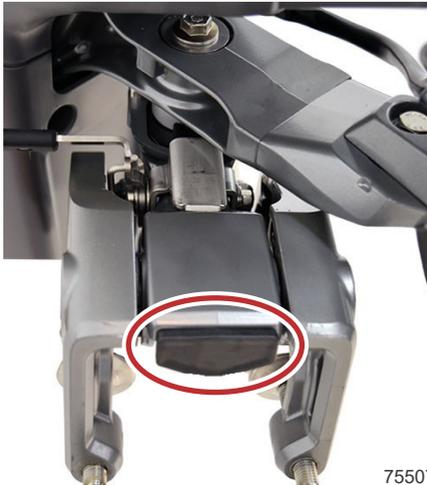
5. Versuchen, den Außenborder anzuheben, um zu überprüfen, ob die Schnellkupplung ordnungsgemäß funktioniert.
