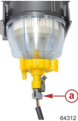
a - Steckverbinder Wasser-im-Kraftstoff-Sensor
