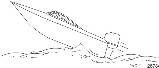
Die größte Gefahr liegt darin, dass das Boot im Sprung die Richtung ändern kann. In diesem Fall kann das Boot bei der Landung scharf eine neue Richtung einschlagen. Durch einen solchen scharfen Richtungswechsel können Insassen von ihren Sitzen oder über Bord geschleudert werden.
