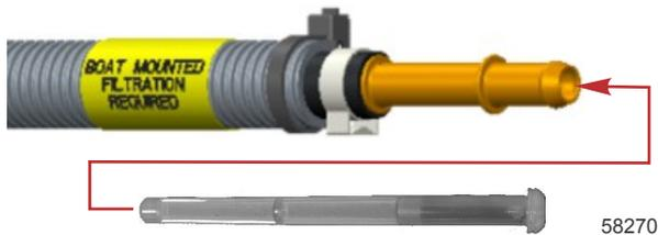
3. Die Kraftstoffleitung des Bootes am Kraftstoffeinlassschlauch anbringen und mit einer Schelle befestigen.
