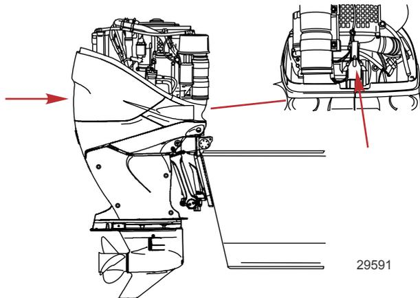
3. Die Motorhaube mit der Vorderseite zuerst über dem Motor positionieren. Sicherstellen, dass sie ordnungsgemäß auf der Gummidichtung sitzt.
