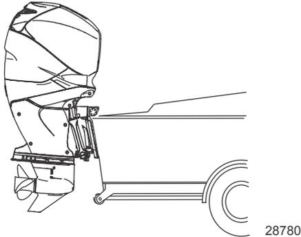
2. Wenn zusätzlicher Bodenabstand erforderlich ist, muss der Außenborder nach oben gekippt und mit der Kippstützhalterung des Außenborders (Trailerstellung) sowie einer Zusatzspiegelstützvorrichtung abgestützt werden. Siehe **Ausstattung und Bedienelemente – Power-Trim- und Kippsystem**.
