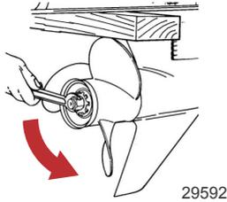
4. Den Propeller gerade von der Welle abziehen.
