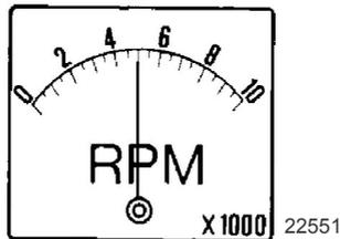
Falls die Drehzahl aufgrund veränderter Bedingungen (wärmeres oder feuchteres Klima, Betrieb in Höhenlagen, erhöhtes Ladegewicht oder Verschmutzung des Bootsbodens/Getriebegehäuses) unter den empfohlenen Bereich abfällt, kann ein Wechsel des Propellers oder eine Reinigung erforderlich sein, um die Leistung und Lebensdauer des Außenborders aufrechtzuerhalten.
