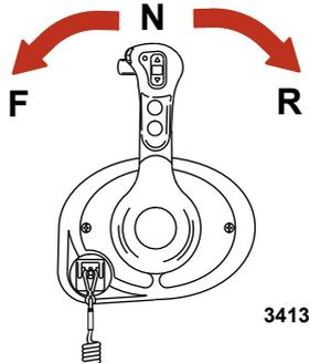
2. Schaltsperrschalter - Durch Drücken auf die Schaltsperrschalter kann das Getriebe geschaltet werden. Die Schaltsperrschalter muss immer gedrückt werden, um den Fernschalthebel aus der Neutralstellung bewegen zu können.
