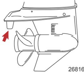
**HINWEIS:** Die Verstellung der Trimmflosse hat nur eine geringe Wirkung auf die Reduzierung des Lenkmoments, wenn der Außenborder so installiert ist, dass die Antiventilationsplatte ca. 50 mm (2 in.) oder mehr über dem Bootsboden montiert ist.
