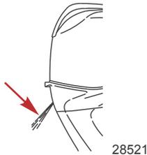
Tritt kein Wasser aus der Wasserpumpenkontrolldüse aus oder ist der Wasserfluss stockend oder unterbrochen, den Motor abstellen und die Kühlwasser-Einlassöffnungen auf Blockierung prüfen. Wird keine Blockierung an der Einlassöffnung festgestellt, kann dies auf eine Blockierung im Kühlsystem oder ein Problem mit der Wasserpumpe hindeuten. Den Außenborder vom Händler prüfen lassen. Der Betrieb des Motors im überhitzten Zustand führt zur Beschädigung des Motors.
