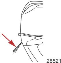
**WICHTIG:** Falls kein Wasser aus der Wasserpumpenkontrolldüse austritt, den Motor abstellen und prüfen, ob die Kühlwasser-Einlassöffnung verstopft ist. Wenn keine Verstopfung vorliegt, kann dies auf eine defekte Wasserpumpe oder eine Verstopfung im Kühlsystem hinweisen. Diese Zustände führen zur Überhitzung des Motors. Den Außenborder vom Händler überprüfen lassen. Der Betrieb des Motors im überhitzten Zustand führt zur Beschädigung des Motors.
