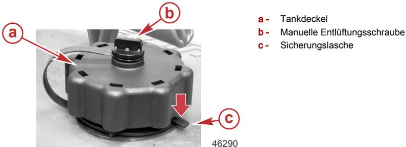
**WICHTIG: Der Inhalt kann unter Druck stehen. Den Tankdeckel eine Viertelumdrehung drehen, um den Druck entweichen zu lassen, bevor der Deckel abgenommen wird.**
