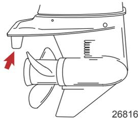
**HINWEIS:** Die Verstellung der Trimmflosse hat nur eine geringe Wirkung auf die Reduzierung des Lenkmoments, wenn der Außenborder so installiert ist, dass die Antiventilationsplatte ca. 50 mm (2 inches) oder mehr über dem Bootsboden montiert ist.
