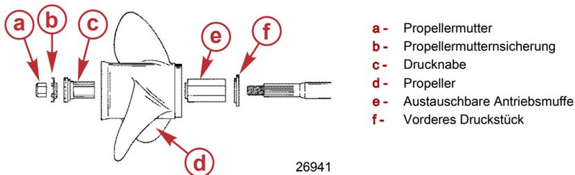
**HINWEIS: Edelstahlanwendungen – Wir empfehlen die Verwendung eines Propellers mit Flo-Torq III Antriebsnabe.**
