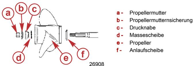
3. Propeller mit Flo-Torque II Antriebsnabe – Das vordere Druckstück, die austauschbare Antriebsmuffe, den Propeller, das Druckstück, die Propellermutternsicherung und die Propellermutter auf der Welle anbringen.
