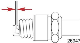
4. Vor Einbau der Zündkerzen Schmutz von den Zündkerzensitzen entfernen. Zündkerzen handfest einbauen und dann um eine Viertelumdrehung oder auf Spezifikation festziehen.
