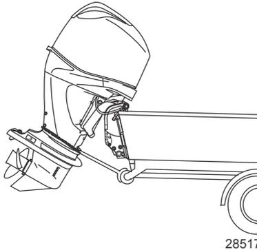
**WICHTIG:** Zur Bewahrung des korrekten Bodenabstands beim Transport auf einem Anhänger nicht auf das Power-Trim-/Kippsystem oder den Kippstützhebel verlassen. Der Kippstützhebel des Außenborders ist nicht dazu vorgesehen, den Außenborder für den Anhängertransport zu stützen.
