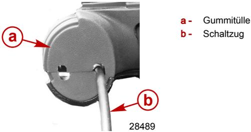
5. Den Schaltzug mit einem Klemmbügel am Schalthebel befestigen.
