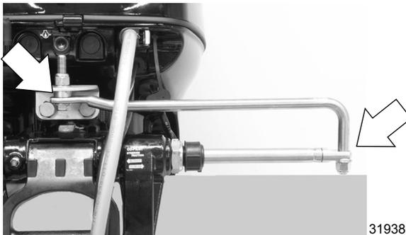
3. Folgende Teile mit Extreme Grease Schmierfett oder 2-4-C mit PTFE schmieren.
