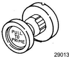
**HINWEIS:** Starten eines abgestoppten Motors - den Anreicherungs-/Leerlaufdrehzahlknopf eindrücken und ganz im Uhrzeigersinn drehen. Den Motor weiter kurbeln, bis er anspringt.
