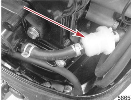
**WICHTIG:** Den Pumpball zusammendrücken, bis er sich prall anfühlt, um Kraftstoff in den Filter zu pumpen. Die Filteranschlüsse dann auf Kraftstofflecks prüfen.
