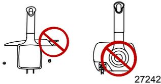
**HINWEIS: Starten eines abgestoppten Motors – Den Neutral-Hochlaufhebel ganz hochschieben und den Motor zum Starten drehen.**
