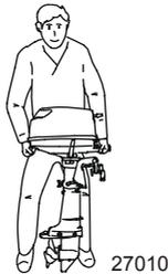
3. Den Außenborder in einer der drei abgebildeten Positionen tragen, transportieren oder lagern. In diesen Positionen kann kein Öl aus dem Kurbelgehäuse auslaufen.
