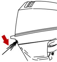
**WICHTIG:** Falls kein Wasser aus der Wasserpumpenkontrolldüse austritt, den Motor abstellen und prüfen, ob die Kühlwasser-Einlassöffnung verstopft ist. Wenn keine Verstopfung vorliegt, kann dies auf eine defekte Wasserpumpe oder eine Verstopfung im Kühlsystem hinweisen. Diese Zustände führen zur Überhitzung des Motors. Den Außenborder vom Händler prüfen lassen. Der Betrieb des Motors im überhitzten Zustand führt zur Beschädigung des Motors.
