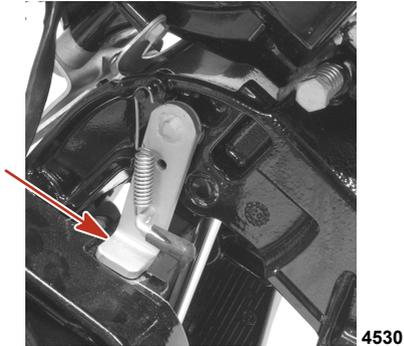
2. Den Einfülldeckel entfernen und den Flüssigkeitsstand prüfen. Der Füllstand muss an der Unterkante der Einfüllöffnung liegen. Power-Trim- und Servolenkflüssigkeit von Quicksilver oder Mercury Precision einfüllen. Wenn diese Flüssigkeit nicht zur Verfügung steht, Automaticgetriebeöl (ATF) verwenden.
