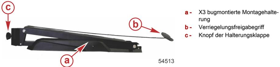
1. Einen geeigneten Anbauort für die Installation der Montagehalterung auf dem Deck des Boots wählen. Sicherstellen, dass die vorderen Befestigungsschrauben den Rumpf nicht berühren.
