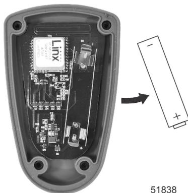
3. Die neue Batterie einlegen, wobei der Pluspol (+) am Pluspol (+) der Batteriehalterung anliegt.
