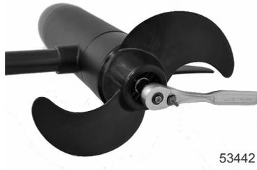
4. Die Propellermutter um eine weitere Vierteldrehung anziehen.
