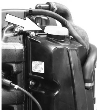
**WICHTIG:** Das Öl auf Anzeichen von Verschmutzung untersuchen. Mit Wasser vermisches Öl sieht milchig aus; mit Kraftstoff vermisches Öl riecht stark nach Kraftstoff. Wenn das Öl kontaminiert ist, muss der Motor vom Händler überprüft werden.
