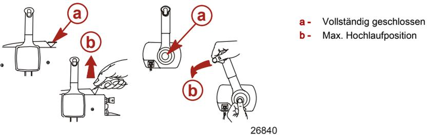
6. Anlassen eines überfluteten Motors – Den Nur-Gas-Hebel oder den Fernschalthebel in die maximale Nur-Gas-Position vorschieben und den Motor zum Anlassen weiter drehen. Die Motordrehzahl reduzieren, sobald der Motor anspringt.
