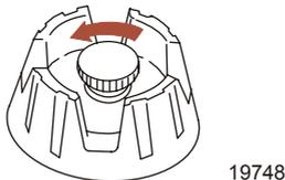
2. Die externe Kraftstoffleitung an den Außenborder anschließen. Sicherstellen, dass das Verbindungsstück einschnappt.
