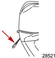
**WICHTIG:** Falls kein Wasser aus der Wasserpumpenkontrolldüse austritt, den Motor abstellen und prüfen, ob die Kühlwasser-Einlassöffnung verstopft ist. Wenn keine Verstopfung vorliegt, kann dies auf eine defekte Wasserpumpe oder eine Verstopfung im Kühlsystem hinweisen. Diese Zustände führen zur Überhitzung des Motors. Den Außenborder vom Händler prüfen lassen. Der Betrieb eines überhitzten Motors kann schwere Motorschäden zur Folge haben.
