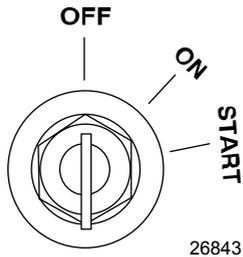
2. **Modelle mit Ruderpinne** - Motordrehzahl zurücknehmen und den Außenborder in Neutral schalten. Den Stoppknopf drücken oder den Zündschlüssel auf „OFF“ (AUS) drehen.
