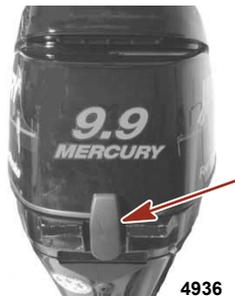
2. Die Vorderseite der Motorhaube an der vorderen Verriegelung vorbei anheben und nach hinten schieben, um den hinteren Haken zu umgehen.
