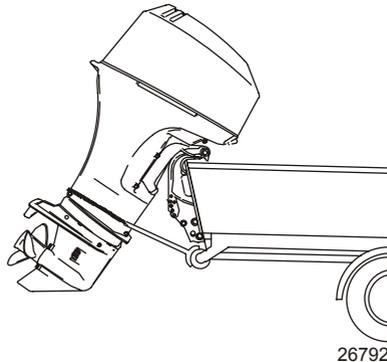
**WICHTIG:** Beim Transport auf einem Anhänger kann man sich nicht darauf verlassen, dass das Kippsystem oder der Kippstützhebel den korrekten Bodenabstand aufrechterhalten. Der Kippstützhebel des Außenborders ist nicht dazu vorgesehen, den Außenborder für den Anhängertransport zu stützen.
