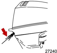
**WICHTIG:** Falls kein Wasser aus der Wasserpumpenkontrolldüse austritt, den Motor abstellen und prüfen, ob die Kühlwasser-Einlassöffnung verstopft ist. Wenn keine Verstopfung vorliegt, kann dies auf eine defekte Wasserpumpe oder eine Verstopfung im Kühlsystem hinweisen. Diese Zustände führen zur Überhitzung des Motors. Den Außenborder vom Händler prüfen lassen. Der Betrieb des Motors im überhitzten Zustand führt zur Beschädigung des Motors.
