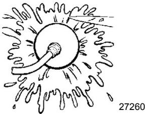
5. Prüfen, ob ein kontinuierlicher Wasserstrahl aus der Wasserpumpenkontrolldüse austritt. Den Außenborder weitere 3 bis 5 Minuten lang spülen und den Wasserdruck dabei stets sorgfältig überwachen.
