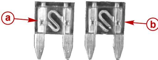
**Erkennen einer durchgebrannten Sicherung**
