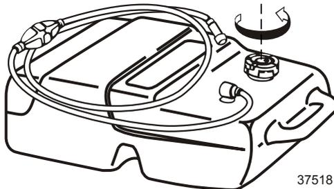
3. Den Pumpball drücken, bis er sich prall anfühlt, um dem Vergaser mit Kraftstoff zu füllen.
