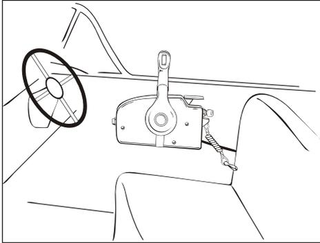
3. Einbau des Fernschaltzugs (auf der Seite des Motors) und des Kabelbaums.
