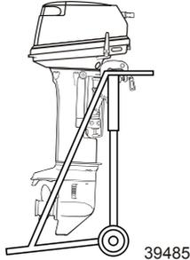
**HINWEIS:** Beim Tragen des Motors in einer horizontalen Position den Motorblock stets höher als der Propeller halten.
