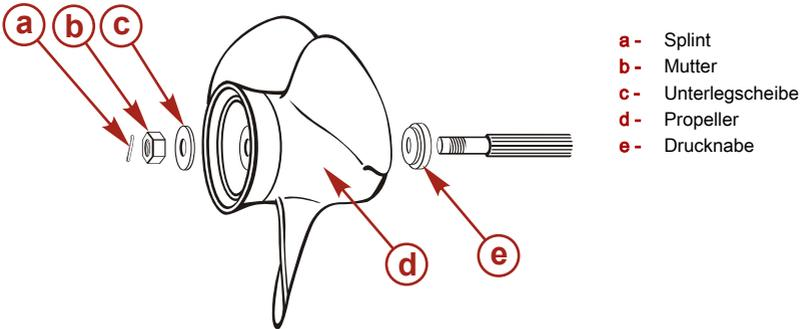
5. Die Propellerwelle mit Mercury Extreme Grease Hochleistungsschmierfett oder 2-4-C mit PTFE schmieren.
