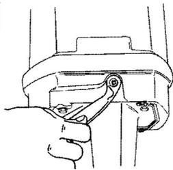
2. Die Rückseite der Motorhaube hochheben und den vorderen Haken lösen.
