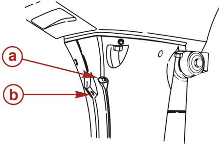
a - Wasserpumpenkontrolldüse
