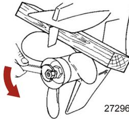
4. Den Propeller von der Welle ziehen. Wenn der Propeller an der Welle fest sitzt und nicht abgenommen werden kann, muss er von einem Vertragshändler abmontiert werden.
