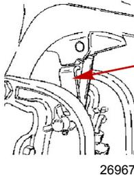
2. Einfülldeckel entfernen und den Flüssigkeitsstand prüfen. Der Füllstand muss an der Unterkante der Einfüllöffnung liegen. Power-Trim- und Servolenkflüssigkeit von Quicksilver oder Mercury Precision einfüllen. Wenn diese Flüssigkeit nicht zur Verfügung steht, Automatikgetriebeöl (ATF) verwenden.
