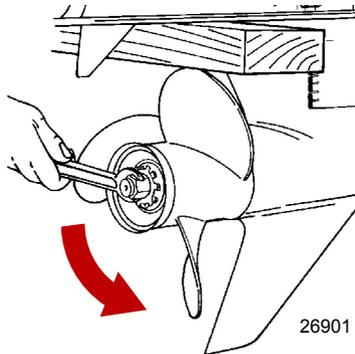
5. Den Propeller gerade von der Welle abziehen. Wenn der Propeller an der Welle festsetzt und nicht abgebaut werden kann, muss er von einem Vertragshändler abmontiert werden.
