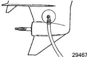
2. Einen Wasserschlauch an den Spülanschluss anschließen. Den Wasserhahn aufdrehen, bis Wasser um die Gummikappen herum austritt, um sicherzustellen, dass der Motor ausreichend mit Kühlwasser versorgt wird.
