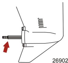
**WICHTIG:** Um Korrosion an der Propellernabe und Festfressen an der Propellerwelle (vor allem in Salzwasser) vorzubeugen, immer eine Schicht des empfohlenen Schmiermittels in den empfohlenen Wartungsintervallen und bei jedem Propellerabbau auf die gesamte Propellerwelle auftragen.
