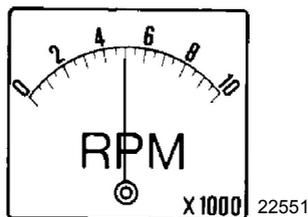
Falls die Drehzahl aufgrund veränderter Bedingungen, wie z. B. wärmeres oder feuchteres Klima, Betrieb in Höhenlagen, erhöhtes Ladegewicht oder Verschmutzung des Bootsbodens/Getriebegehäuses, unter den empfohlenen Bereich abfällt, kann ein Wechsel des Propellers oder eine Reinigung erforderlich sein, um die Leistung und Lebensdauer des Außenborders aufrechtzuerhalten.
