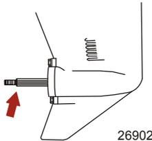
**WICHTIG: Um Korrosion an der Propellermabe vorzubeugen und Festfressen an der Propellerwelle (vor allem in Salzwasser) vorzubeugen, immer das empfohlene Schmiermittel in den empfohlenen Wartungsintervallen und bei jedem Propellerabbau auf die gesamte Propellerwelle auftragen.**
