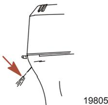
Wenn kein Wasser aus der Wasserpumpenkontrolldüse austritt oder der Wasserfluss nur schubweise erfolgt, den Motor abstellen und die Kühlwasser-Einlassöffnungen auf Verstopfung prüfen. Liegt am Einlass keine Verstopfung vor, kann dies auf eine Verstopfung im Kühlsystem oder ein Problem mit der Wasserpumpe hindeuten. Den Außenborder vom Händler prüfen lassen. Der Betrieb des Motors im überhitzten Zustand führt zur Beschädigung des Motors.
