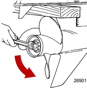
5. Den Propeller gerade von der Welle abziehen. Wenn der Propeller an der Welle fest sitzt und nicht abgebaut werden kann, muss er von einem Vertragshändler abmontiert werden.
