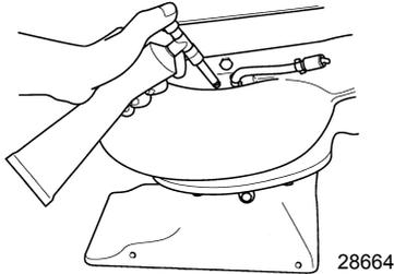
2. Die Kraftstofftank-Entlüftungsschraube (im Einfülldeckel) an Kraftstofftanks mit manueller Entlüftung öffnen.
