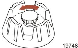
3. Den Kraftstoffleitungs-Pumpball so drehen, dass der Pfeil auf der Seite des Balls nach oben zeigt. Den Pumpball mehrmals zusammendrücken, bis er sich prall anfühlt.
