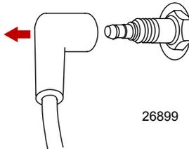
2. Die Zündkerzen ausbauen. Die Zündkerze austauschen, wenn die Elektrode verschlissen ist, wenn der Isolator rau, gerissen, gebrochen ist oder Blasen aufweist bzw. wenn das Edelmetall der Elektrode nicht sichtbar ist.
