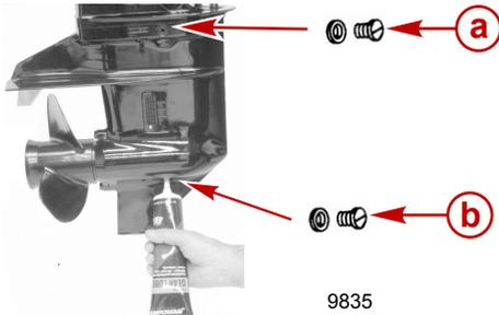
**a** - Entlüftungsschraube und Dichtungsscheibe
