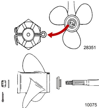
**WICHTIG:** Um Korrosion an der Propellernabe vorzubeugen und Festfressen an der Propellerwelle (vor allem in Salzwasser) vorzubeugen, immer eine Schicht des empfohlenen Schmiermittels in den empfohlenen Wartungsintervallen und bei jedem Propellerabbau auf die gesamte Propellerwelle auftragen.
