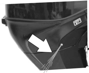
**WICHTIG:** Falls kein Wasser aus der Wasserpumpenkontrolldüse austritt, den Motor abstellen und prüfen, ob die Kühlwasser-Einlassöffnung verstopft ist. Wenn keine Verstopfung vorliegt, kann dies auf eine defekte Wasserpumpe oder eine Verstopfung im Kühlsystem hinweisen. Diese Zustände führen zur Überhitzung des Motors. Den Außenborder vom Händler prüfen lassen. Der Betrieb eines überhitzten Motors kann schwere Motorschäden zur Folge haben.
