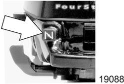
**HINWEIS:** Starten eines abgeseffenen Motors - Den Chokeknopf einschieben. 30 Sekunden warten und dann den Motor zum Anlassen drehen.
