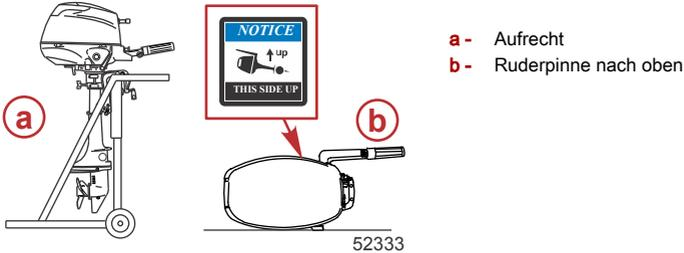
2. Den Außenborder niemals in den nachstehend abgebildeten Positionen tragen, lagern oder transportieren, um zu vermeiden, dass Öl aus dem Kurbelgehäuse ausläuft und Motorschäden verursacht.
