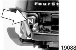
Gasgriff-Reibmomentwiderstandsknopf - Den Knopf drehen, um den Motor auf die gewünschte Drehzahl einzustellen und dort zu halten. Den Knopf im Uhrzeigersinn drehen, um den Widerstand zu erhöhen oder gegen den Uhrzeigersinn, um den Widerstand zu verringern.
