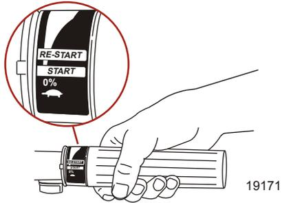
8. Bei kaltem Motor den Choke vollständig herausziehen. Den Choke zur Hälfte einschieben, während der Motor warmläuft. Vollständig einschieben, nachdem der Motor warmgelaufen ist.
