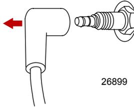
2. Zur Inspektion die Zündkerze ausbauen. Die Zündkerzen austauschen, wenn die Elektrode verschlissen oder der Isolator rau, gerissen, gebrochen oder verschmutzt ist.
