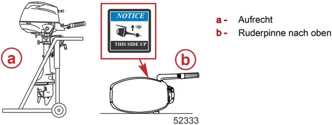
Den Außenborder niemals in einer dieser Positionen tragen, lagern oder transportieren, um zu vermeiden, dass Öl aus dem Kurbelgehäuse ausläuft und Motorschäden verursacht.
