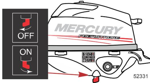
Chokeknopf - Zum Anlassen bei kaltem Motor vollständig herausziehen. Zur Hälfte einschieben, während der Motor warmläuft. Vollständig einschieben, nachdem der Motor warmgelaufen ist.
