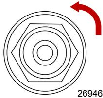
3. Den Elektrodenabstand auf Spezifikation einstellen.
