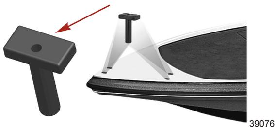
**HINWEIS:** Wenn keine Befestigungsisolatoren aus Gummi verwendet werden, sollten zwischen dem Sockel der Halterung und der Montagefläche am Boot ein Gummidistanzstück oder eine Gummischeibe verwendet werden.
