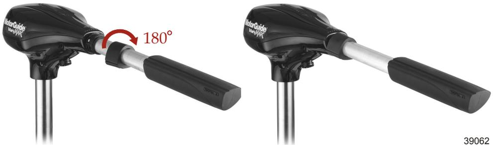
5. Zum Arretieren der Pinne die Pinne festhalten und die Cam-Lock-Verriegelung um 180° im Uhrzeigersinn festziehen. Sicherstellen, dass die flachen Oberflächen von Pinne, Cam-Lock-Verriegelung und oberem Gehäuse miteinander ausgerichtet sind.
