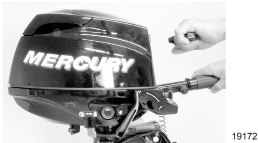
10. Prüfen, ob ein kontinuierlicher Wasserstrahl aus der Wasserpumpenkontrolldüse austritt.
