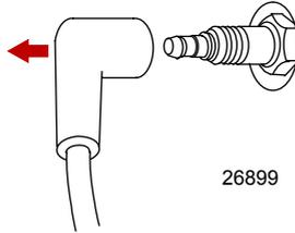
2. Zur Inspektion die Zündkerze ausbauen. Die Zündkerzen auswechseln, wenn die Elektrode verschlissen oder der Isolator rau, gerissen, gebrochen oder verschmutzt ist.
