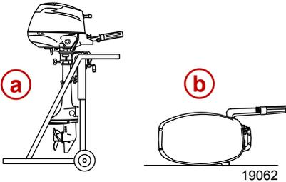
2. Den Außenborder niemals in den nachstehend abgebildeten Positionen tragen, lagern oder transportieren, um zu vermeiden, dass Öl aus dem Kurbelgehäuse läuft und Motorschäden verursacht.
