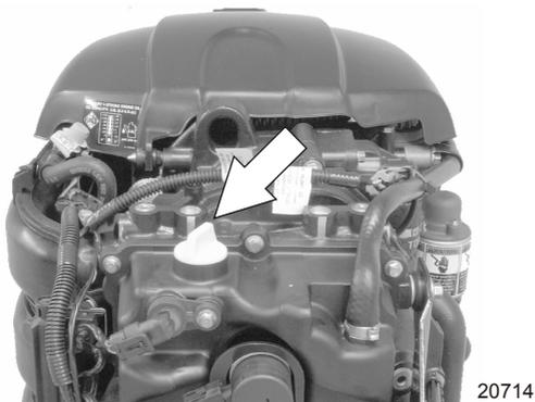
**WICHTIG: Das Öl auf Anzeichen von Verschmutzung untersuchen. Mit Wasser vermisches Öl sieht milchig aus; mit Kraftstoff vermisches Öl riecht stark nach Kraftstoff. Wenn das Öl kontaminiert ist, muss der Motor vom Händler überprüft werden.**
