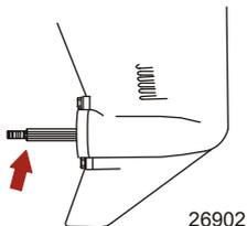
2. Folgende Teile mit Quicksilver oder Mercury Precision Lubricants 2-4-C mit Teflon oder Spezialschmiermittel 101 schmieren.
