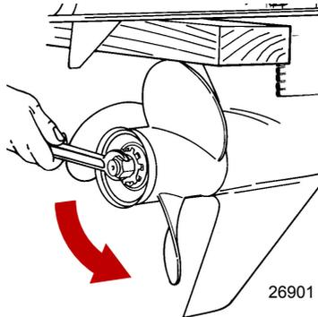
4. Den Propeller gerade von der Welle abziehen.
