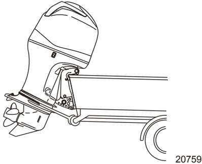
**WICHTIG:** Zur Bewahrung des korrekten Bodenabstandes bei Transport auf einem Anhänger nicht auf das Power-Trim-/Kippsystem oder den Kippstützhebel verlassen. Der Kippstützhebel des Außenborders ist nicht dazu vorgesehen, den Außenborder für den Anhängertransport zu stützen.
