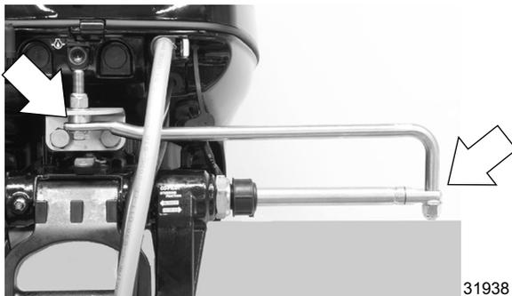
3. Die folgenden Stellen mit Quicksilver oder Mercury Precision Lubricants Korrosionsschutzfett oder 2-4-C mit Teflon schmieren.
