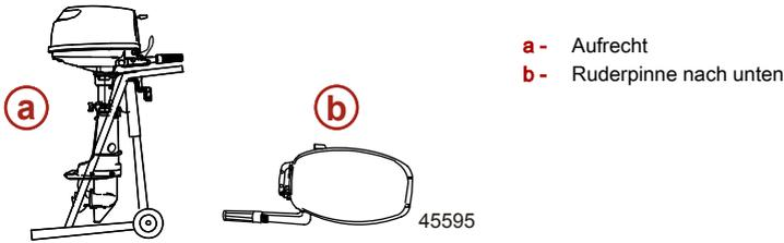
**HINWEIS:** Den Außenborder niemals in einer dieser Positionen tragen, lagern oder transportieren, um zu vermeiden, dass Öl aus dem Kurbelgehäuse ausläuft und Motorschäden verursacht.
