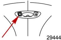
2. Einen Wasserschlauch an das Fitting anschließen. Das Wasser aufdrehen und 3 bis 5 Minuten lang spülen.
