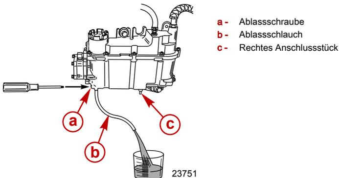
5. Die Ablassschraube wieder anziehen und den Schlauch wieder anschließen.
