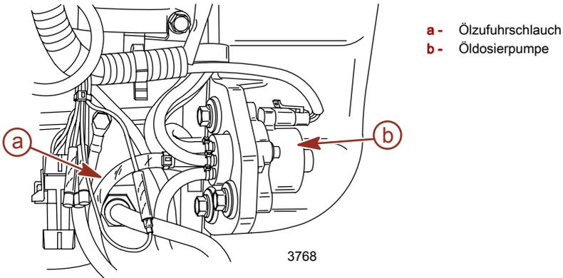
**WICHTIG: Das Kraftstoffsystem des Motors füllen, bevor die Öldosierpumpe angereichert wird. Andernfalls läuft die Kraftstoffpumpe während des Anreicherungsverfahrens ohne Kraftstoff und kann beschädigt werden.**
