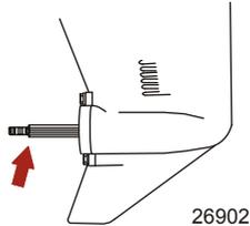
3. Folgende Teile mit Quicksilver oder Mercury Precision Lubricants 2-4-C mit PTFE oder Spezialschmiermittel 101 schmieren.
