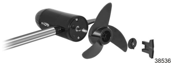
4. Die Propellermutter mit einem MotorGuide Propellerschlüssel oder einer Zange eine weitere Vierteldrehung festziehen.
