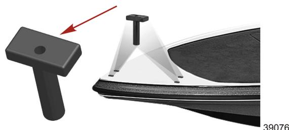
6. Die Halterung auf die Isolatoren setzen und die Löcher ausrichten. Die beiden längeren Schrauben in die vorderen Befestigungsbohrungen und die beiden kürzeren Schrauben in die hinteren Befestigungsbohrungen einsetzen. Alle Befestigungsschrauben mit einem Kreuzschlitzschraubendreher fest anziehen.
