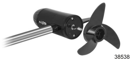
3. Die Propellermutter aufschrauben und fest anziehen.
