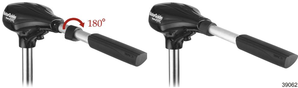
6. Zum Arretieren der Tri-Lobe-Pinne die Pinne festhalten und die Cam-Lock-Verriegelung um 180° im Uhrzeigersinn festziehen. Sicherstellen, dass die flachen Oberflächen von Pinne, Cam-Lock-Verriegelung und oberem Gehäuse miteinander ausgerichtet sind.
