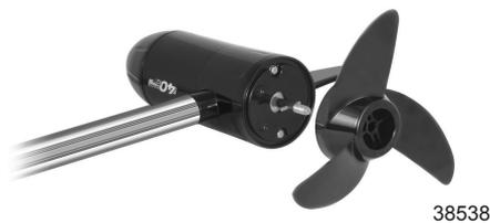
3. Die Propellermutter aufschrauben und fest anziehen.
