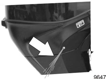
**WICHTIG:** Falls kein Wasser aus der Wasserpumpenkontrolldüse austritt, den Motor abstellen und prüfen, ob die Kühlwasser-Einlassöffnung verstopft ist. Wenn keine Verstopfung vorliegt, kann dies auf eine defekte Wasserpumpe oder eine Verstopfung im Kühlsystem hinweisen. Diese Zustände führen zur Überhitzung des Motors. Den Außenborder vom Händler prüfen lassen. Der Betrieb eines überhitzten Motors kann schwere Motorschäden zur Folge haben.
