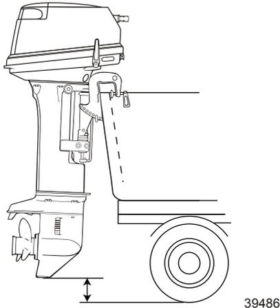
Den Vorwärtsgang einlegen. Hierdurch wird verhindert, dass sich der Propeller frei dreht.
