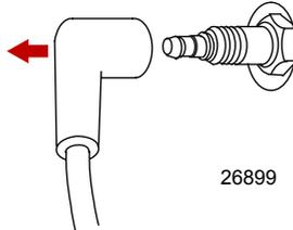
2. Die Zündkerzen ausbauen und untersuchen. Die Zündkerze austauschen, wenn die Elektrode verschlissen oder der Isolator rau, gerissen, gebrochen oder verschmutzt ist bzw. Blasen aufweist.
