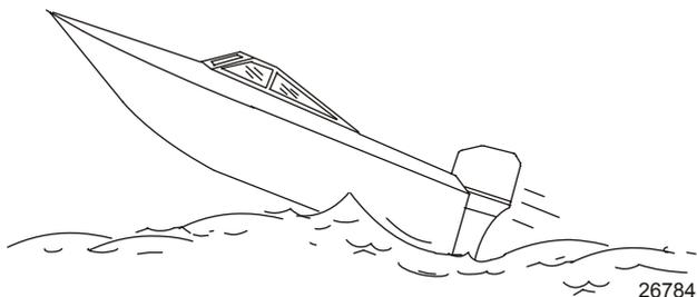
Hauptproblem ist der Richtungswechsel des Bootes während eines Sprunges. In diesem Fall kann das Boot bei der Landung ruckartig eine andere Richtung einschlagen. Bei einer solch scharfen Richtungsänderung können Passagiere von ihren Sitzen oder über Bord geschleudert werden.
