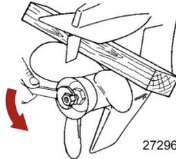
4. Den Propeller gerade von der Welle abziehen. Wenn der Propeller an der Welle festsitzt und nicht abgebaut werden kann, muss er von einem Vertragshändler abmontiert werden.
