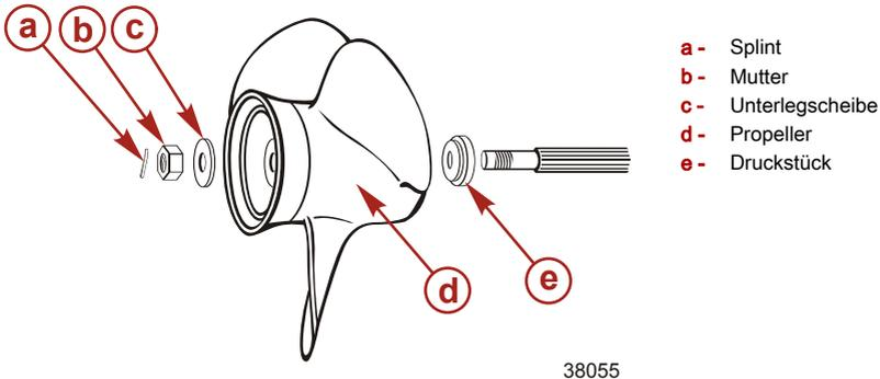
5. Die Propellerwelle mit Quicksilver oder Mercury Precision Lubricants Korrosionsschutzfett oder 2-4-C mit Teflon schmieren.
