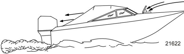
**Beispiel einer optimalen Belüftung des Boots**
