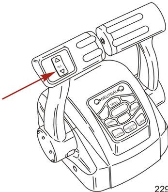
2. Neutralleuchten - Die Neutralleuchten leuchten auf, wenn sich der Motor in der Neutralstellung befindet. Die Leuchten blinken, wenn sich der Motor im „Nur Gas“-Modus befindet.
