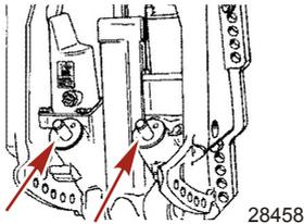
2. Die folgenden Stellen mit Quicksilver oder Mercury Precision Lubricants Korrosionsschutzfett oder 2-4-C mit Teflon schmieren.
