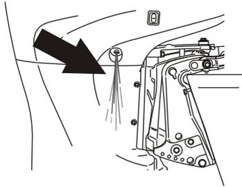
**WICHTIG:** Falls kein Wasser aus der Wasserpumpenkontrolldüse austritt, den Motor abstellen und prüfen, ob die Kühlwasser-Einlassöffnung verstopft ist. Wenn keine Verstopfung vorliegt, kann dies auf eine defekte Wasserpumpe oder eine Verstopfung im Kühlsystem hinweisen. Diese Zustände führen zur Überhitzung des Motors. Den Außenborder vom Händler prüfen lassen. Der Betrieb des Motors im überhitzten Zustand führt zur Beschädigung des Motors.
