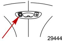
2. Einen Wasserschlauch an das Fitting anschließen. Das Wasser aufdrehen und 3 bis 5 Minuten lang spülen.
