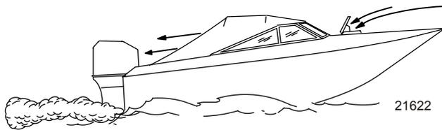
Beispiel einer optimalen Belüftung des Boots
