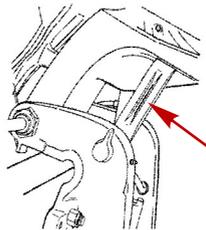
2. Einfülldeckel entfernen und den Flüssigkeitsstand prüfen. Die Flüssigkeit muss bis zur Unterkante der Einfüllöffnung reichen. Power-Trim- und Servolenkflüssigkeit von Quicksilver oder Mercury Precision einfüllen. Wenn diese Flüssigkeit nicht zur Verfügung steht, Automatikgetriebeöl (ATF) verwenden.
