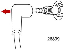
2. Zur Inspektion die Zündkerzen ausbauen. Die Zündkerzen auswechseln, wenn die Elektrode verschlissen oder der Isolator rau, gerissen, gebrochen oder verschmutzt ist.
