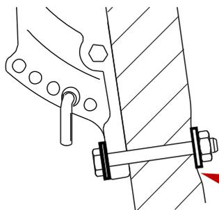
**a -** Spiegelplatte gibt unter dem Anzugsdrehmoment der Schraube nach
