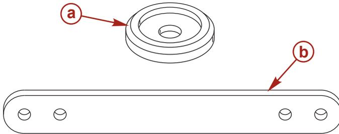
a - Große Spiegelplatten-Unterlegscheibe      b - Spiegelverstärkungsplatte
