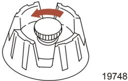
3. Den Kraftstoffleitungs-Pumpenball so drehen, dass der Pfeil auf der Seite des Balls nach oben zeigt. Den Pumpenball zusammendrücken, bis er sich prall anfühlt.
