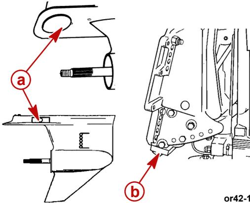
**a** - Opferanoden (Getriebegehäuse)
