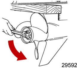
5. Den Propeller gerade von der Welle abziehen. Wenn der Propeller an der Welle festsitzt und nicht abgebaut werden kann, muss er von einem Vertragshändler entfernt werden.
