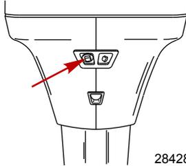
2. Einen Wasserschlauch an das Fitting anschließen. Das Wasser aufdrehen und 3 bis 5 Minuten lang spülen.
