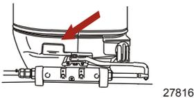
2. Die hintere Motorhaubenverriegelung anheben. Die Motorhaube abnehmen.
