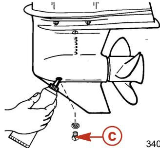
c - Einfüll-/Ablassschraube
