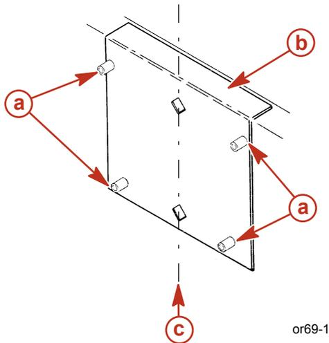
**a** - Bohrer-Führungsbohrungen
