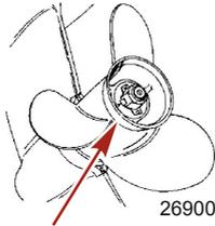
4. Einen Holzblock zwischen Getriebegehäuse und Propeller klemmen, um den Propeller zu fixieren. Die Propellermutter entfernen.
