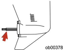
**WICHTIG: Um Korrosion der Propellernabe und Festfressen an der Propellerwelle (vor allem in Salzwasser) vorzubeugen, immer eine Schicht des empfohlenen Schmiermittels in den empfohlenen Wartungsintervallen und bei jedem Propellerabbau auf die gesamte Propellerwelle auftragen.**
