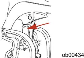
2. Einfülldeckel entfernen und den Flüssigkeitsstand prüfen. Die Flüssigkeit muss bis zur Unterkante der Einfüllöffnung reichen. Power-Trim- und Servolenkungsflüssigkeit von Quicksilver oder Mercury Precision einfüllen. Wenn diese Flüssigkeit nicht zur Verfügung steht, Automatikgetriebeöl (ATF) verwenden.
