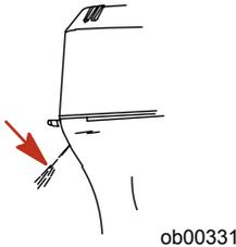
**WICHTIG:** Falls kein Wasser aus der Wasserpumpenkontrolldüse austritt, den Motor abstellen und prüfen, ob die Kühlwasser-Einlassöffnung verstopft ist. Wenn keine Verstopfung vorliegt, kann dies auf eine defekte Wasserpumpe oder eine Verstopfung im Kühlsystem hinweisen. Diese Zustände bewirken eine Überhitzung des Motors. Den Außenborder vom Händler prüfen lassen. Der Betrieb eines überhitzten Motors kann schwere Motorschäden zur Folge haben.
