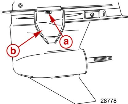
**a** - Ablassschraube/Dichtring
