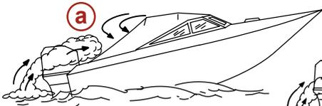
**a-** Betrieb des Boots mit hoch eingestelltem Bugtrimmwinkel
