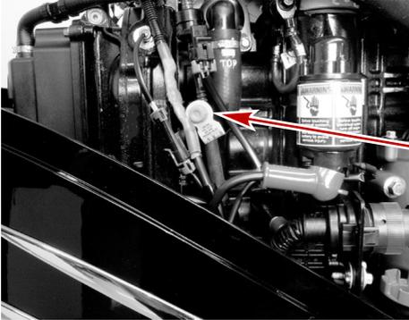
**a** - Kraftstoffdampf-Entlastungsventil
