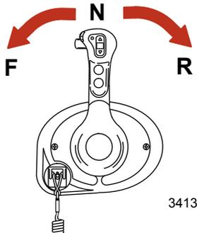
2. Schaltsperre - Durch Drücken auf die Schaltsperre kann das Getriebe geschaltet werden. Die Schaltsperre muss immer gedrückt werden, um den Schalthebel aus der Neutralstellung bewegen zu können.
