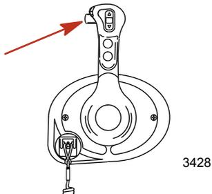
3. Trimmshalter (falls vorhanden) - Durch Drücken auf den Trimmshalter kann der Motor auf- oder abwärts getrimmt werden.
