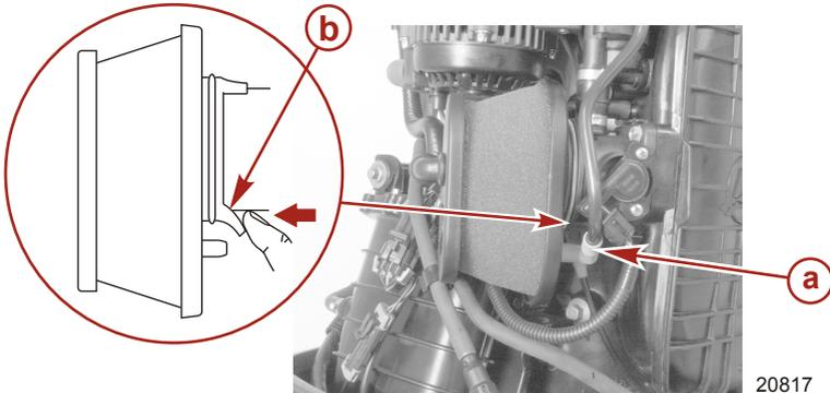
**a** - Entlüftungsrohr
