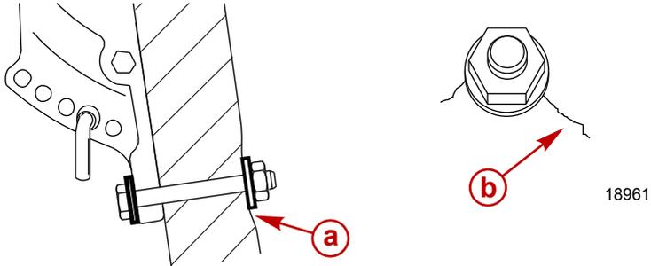
**a -** Spiegelplatte gibt unter dem Anzugsdrehmoment der Schraube nach
