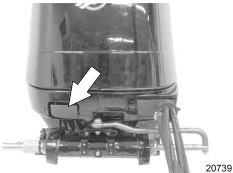
2. Die hintere Motorhaubenverriegelung nach unten ziehen. Die Motorhaube abnehmen.
