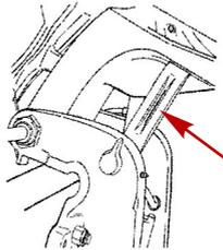
2. Einfülldeckel entfernen und den Flüssigkeitsstand prüfen. Die Flüssigkeit muss bis zur Unterkante der Einfüllöffnung reichen. Power-Trim- und Servolenkungsöl von Quicksilver oder Mercury Precision einfüllen. Wenn diese Flüssigkeit nicht zur Verfügung steht, Automatikgetriebeöl (ATF) verwenden.
