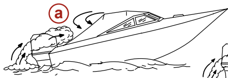
a - Betrieb des Boots mit zu hoch eingestelltem Bugtrimmwinkel
