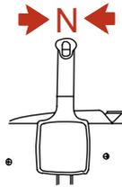
2. Den Gaszug mit einer Unterlegscheibe und Kontermutter am Drosselklappenhebel befestigen. Die Kontermutter fest anziehen und dann eine Viertelumdrehung lösen.
