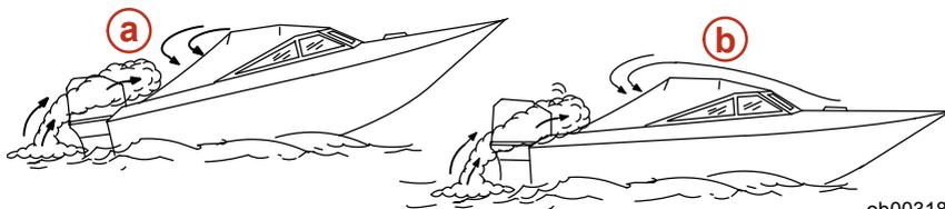
**a-** Betrieb des Boots mit zu hoch eingestelltem Bugtrimmwinkel.
