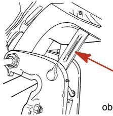
2. Einfülldeckel entfernen und den Flüssigkeitsstand prüfen. Die Flüssigkeit muss bis zur Unterkante der Einfüllöffnung reichen. Power-Trim- und Servolenkungsöl von Quicksilver oder Mercury Precision einfüllen. Wenn diese Flüssigkeit nicht zur Verfügung steht, Automatikgetriebeöl (ATF) verwenden.
